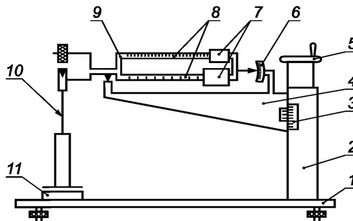
1 — стол; 2 — стойка; 3 — измерительная шкала с нониусом; 4 — подвижный кронштейн; 5 — маховичок; 6 — установочная шкала; 7 — передвигаемые грузы; 8 — шкала нагрузки; 9 — коромысло; 10 — подвеска коромысла; 11 — проба
